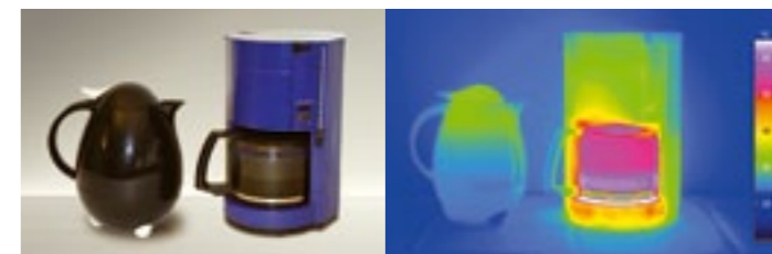
Abb. 2.1.2 Thermoskanne und Kaffeemaschine im Vergleich bzgl. Wärmespeicherung
